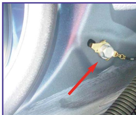
**NOTE:** Le connessioni dovranno essere eseguite con saldatura del cavo o crimpatura, e isolate tramite guaina termoretraibile o nastro isolante.
