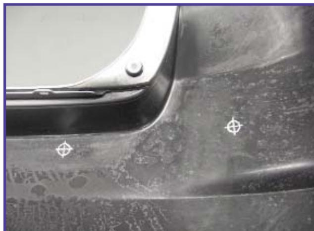
Si consiglia di eseguire preventivamente un foro di centraggio  $\varnothing 2,5\text{mm}$  dall'interno verso l'esterno. Successivamente con una fresa adeguata da 19 mm (accessorio V65FRES) forare dall'esterno (parte verniciata de paraurti) verso l'interno.
