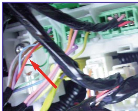
**NEGATIVO :** Per il collegamento elettrico individuare la diramazione d'origine dietro battitacco lato guida.
